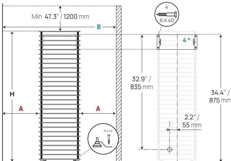
\* On fixe le poêle CLIFF Mini 4 au mur à l'aide d'un support spécial. Pour en savoir plus sur les caractéristiques techniques du poêle CLIFF Mini 4 veuillez voir le tableau ci-dessous.
