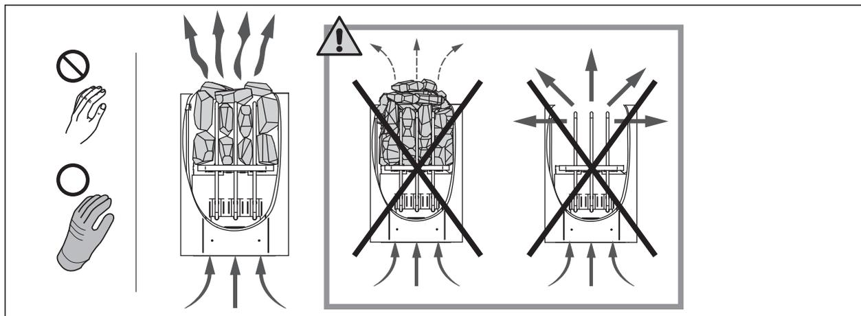
Figure 1. Mise en place des pierres du poêle
