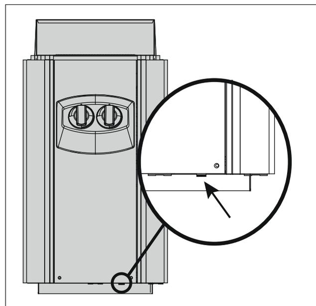
Figure 8. Réinitialiser les boutons pour les sécurités surchauffe.
